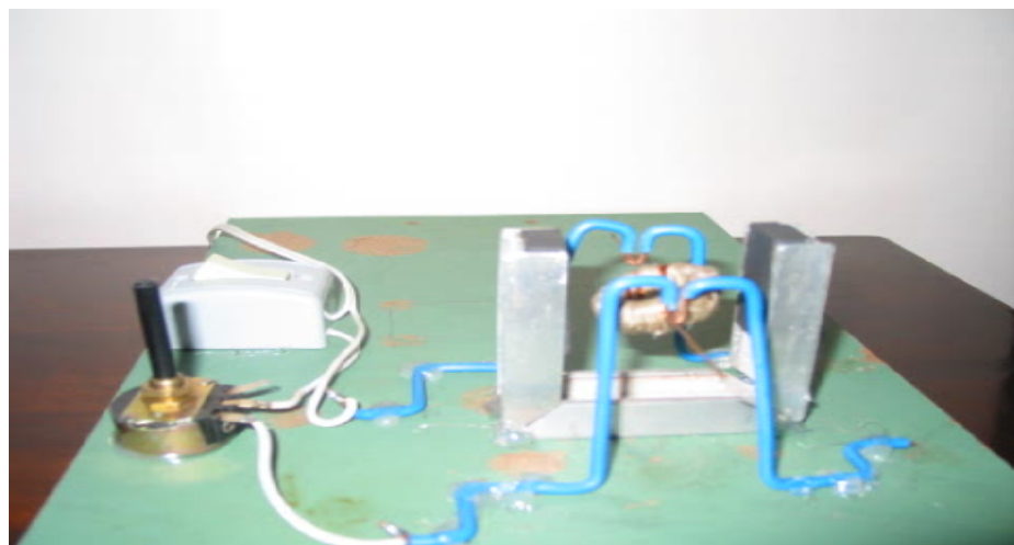
Figura 1: Foto do experimento: motor de corrente contínua, construído pelos alunos do 3º ano do Colégio Estadual Piratini, no ano de 2003.
